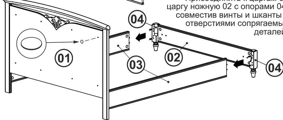
Порядок сборки сегментных стяжек аналогичен показанному при сборке царги 02 и опор 04. Установить заглушки самоклеящиеся с обратной стороны спинки головной 01, закрыв отверстия для крепления мягкого элемента (мягкий элемент приобретается отдельно).
